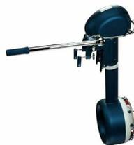
Le Fin5 est le premier produit FinX. Moteur de bateau à nageoire 2 kW (équivalent 5 CV thermique), il est 100% électrique et dédié aux petites embarcations et voiliers jusqu'à 3 tonnes. Concevoir des transports propres et durables est l'un des grands défis du siècle. Convaincu que le monde de demain sera inspiré de la nature, FinX a décliné
