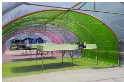
le photobioréacteur (rendement et coût élevés) et le raceway (rendement et coût réduits). Elle permet de bénéficier de leurs avantages respectifs (rendement élevé et coût réduit). Ce nouveau concept s'appuie sur les techniques modernes de design et de pilotage des serres (INRA), et mobilise les compétences de spécialistes en microalgues (LOV et INRIA), en technologies PV (SunPartner et Armines), en calcul numérique, et en étude d'impacts (ACRI et l'INRIA).
