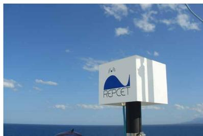
système de détection acoustique. REPCET sera testé dans la zone du Sanctuaire Pelagos où il s'inscrit dans la lignée d'une série de travaux et de mesures pour limiter les risques de collisions.
