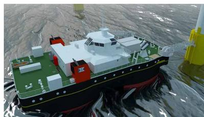
La sûreté et sécurité des champs éoliens. WindKeeper s'inscrit dans un objectif de maintenance sur site jusqu'à des hauteurs de vagues  $\leq 3$  m.
