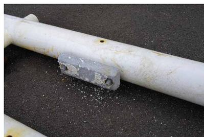
projet ANODE est de quantifier les composés chimiques émis par les anodes galvaniques des structures EMR et le risque associé à leur dispersion dans le milieu marin.
