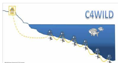
paramètres du milieu (oxygène dissous, température, salinité ...). Les boîtiers sont montés «en ligne» ou «en étoile» pour couvrir de grandes surfaces. C4WILD dispose également d'une intelligence de type «deep learning» de 1er niveau lui permettant de reconnaître les formes animales par analyse et apprentissage de leur morphologie.
